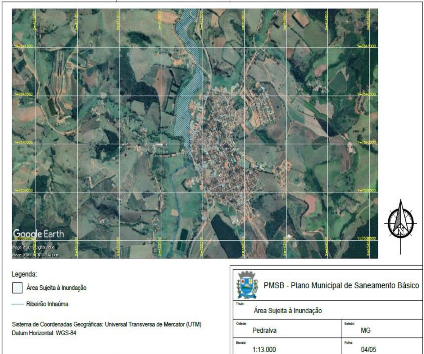
Figura 5.22. Área urbana sujeita a inundação ao longo do ribeirão Inhaúmas.
